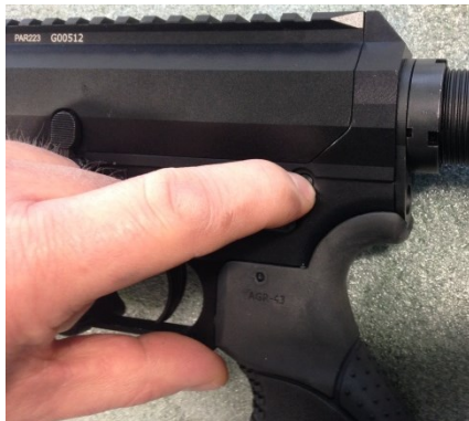
Zerlegestift drücken und an rechter Seite herausziehen
