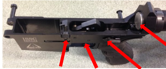
Unterteil: Bedienteile, Abzug, Sicherung und Puffer
