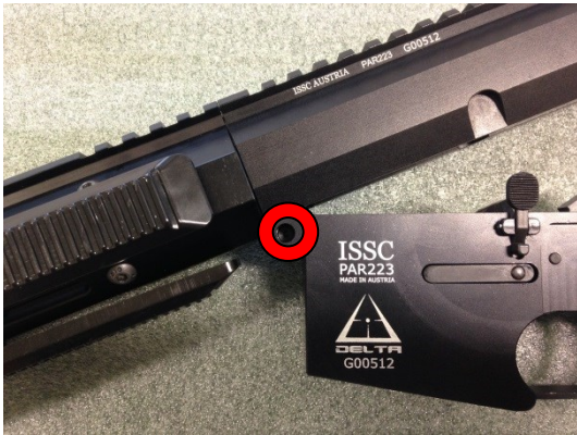
Oberteil aufsetzen und zentrieren
