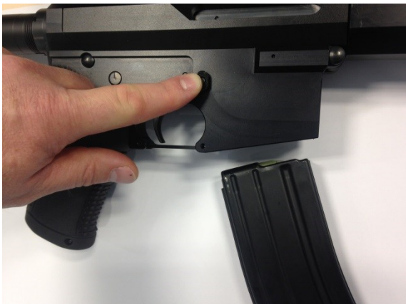
Drücken des Magazinhalteknopfs und Magazin herausnehmen
