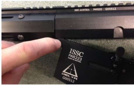
Zerlegestift drücken und an rechter Seite herausziehen
