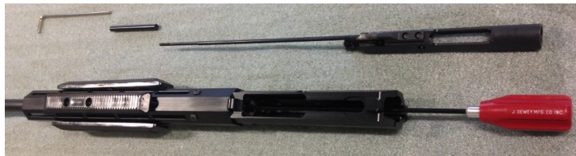
Zum Reinigen: Putzstock von der Patronenlagerseite
