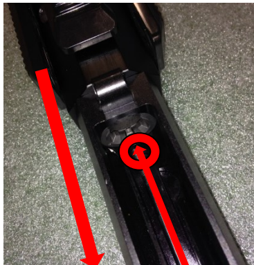
Spanngriff hinten, Einfädeln der Schubstange in die Gehäusebohrung
